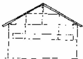
3. **tipologia di tetto inadeguata:** modesto ampliamento per eliminare il dislivello tra le due falde estendendo l'operazione di riqualificazione estetica all'intera facciata
