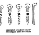
esempi di chiodi usati per il fissaggio delle scandole
