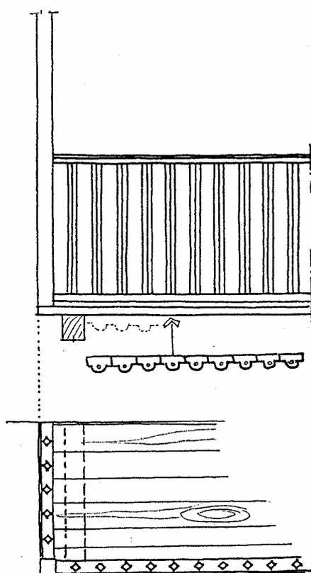
tipologia tradizionale di parapetto in legno composto da due correnti collegate da montantini quadrati disposti in allineamento lungo la loro diagonale di sezione
