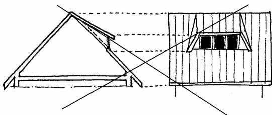
2. **falda molto inclinata con abbaino:** adeguamento della pendenza del tetto e sostituzione dell'abbaino con finestra a nastro sottofalda e lucernario tipo velux
