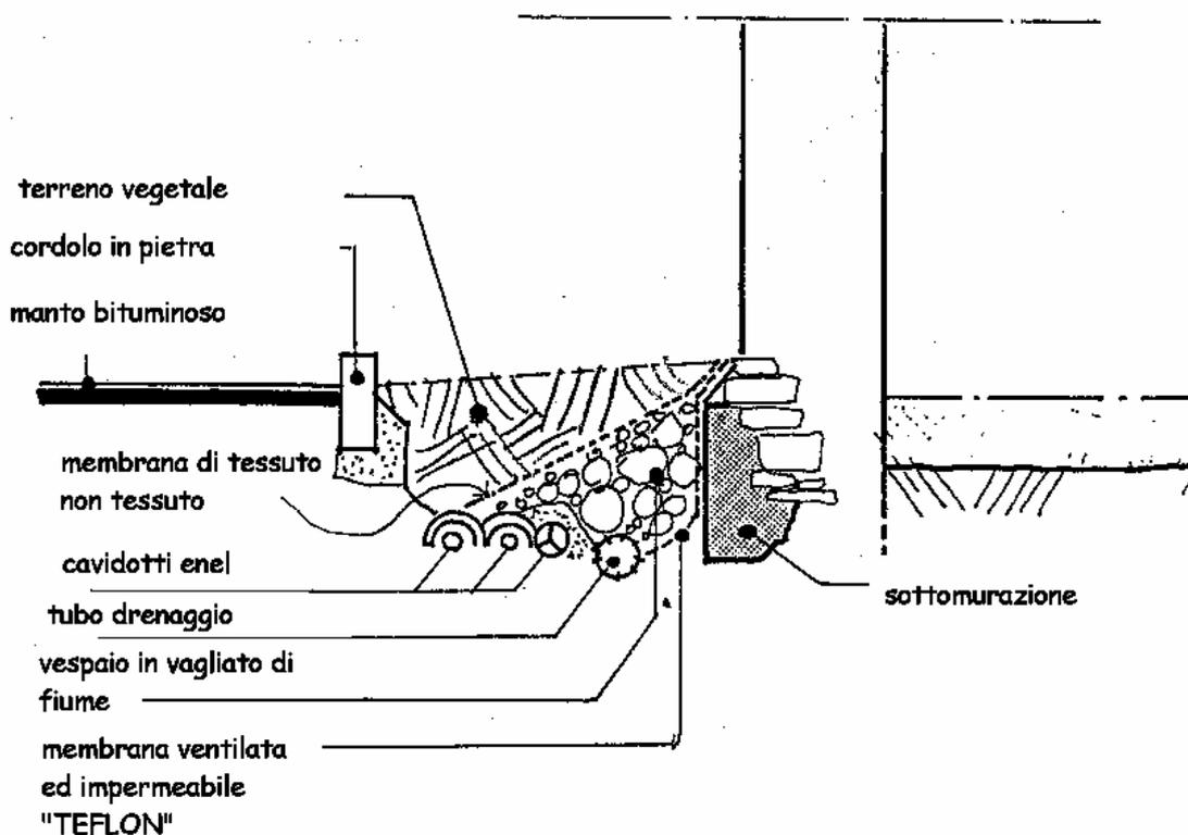
Schema di contromurazione e protezione dall'umidità con vespaio esterno
