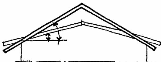
1. **falda poco inclinata:** adeguamento della pendenza secondo le tipologie locali con un modesto aumento di cubatura
