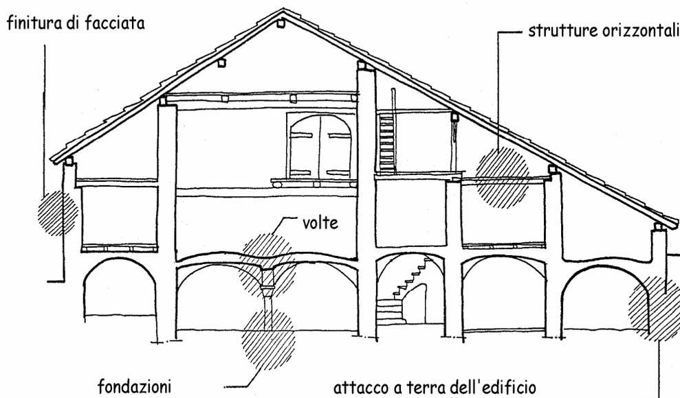
Gli interventi sulle facciate degli edifici tradizionali di origine rurale devono considerare che operazioni come reintonacare per il solo fine di rendere uniforme la facciata, utilizzare intonaci cementizi per "rinsaldare" la muratura, rivestire in pietre regolari o ad opus incertum, così come l'ostentato inserimento di resti di antichi elementi non originari, possono causare anche danni e alterazioni irrimediabili.
