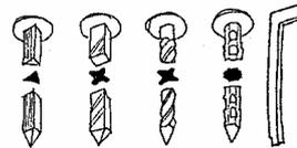
esempi di chiodi usati per il fissaggio delle scandole
