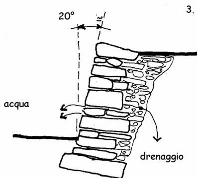
Schemi di sistemazione di scarpate mediante tecniche di ingegneria naturalistica:
