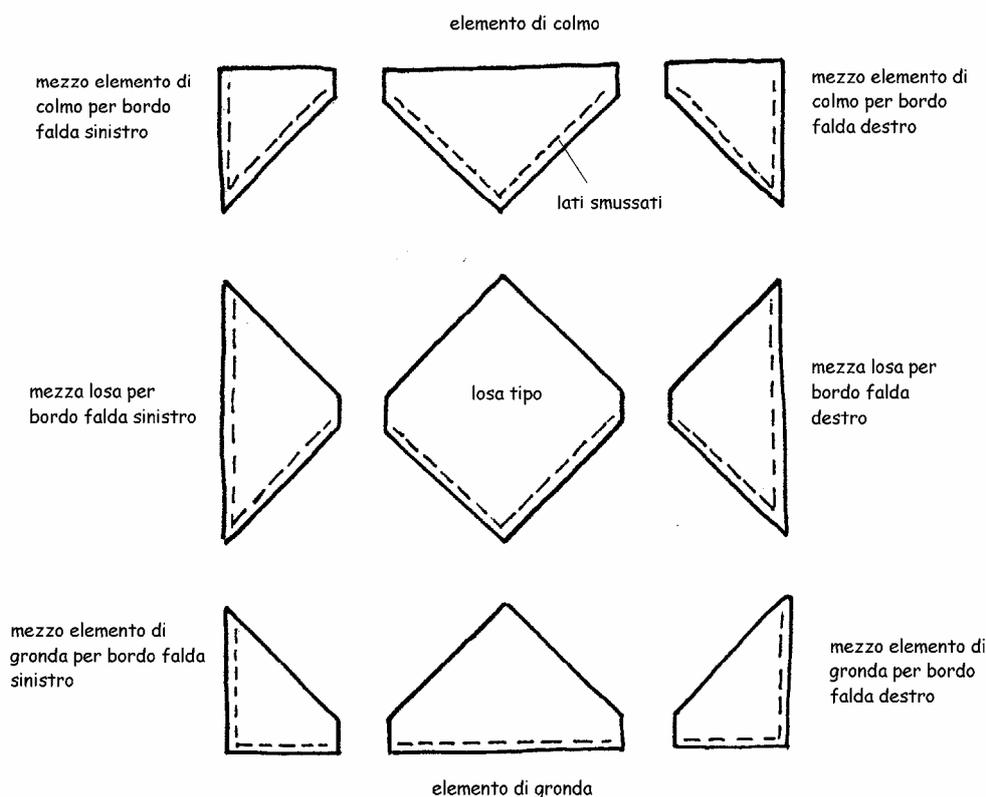
NB. gli elementi di gronda e di colmo sono da ricavare da una losa di dimensioni maggiorata rispetto alla losa tipo della misura della sovrapposizione (10 cm circa in più per lato)
