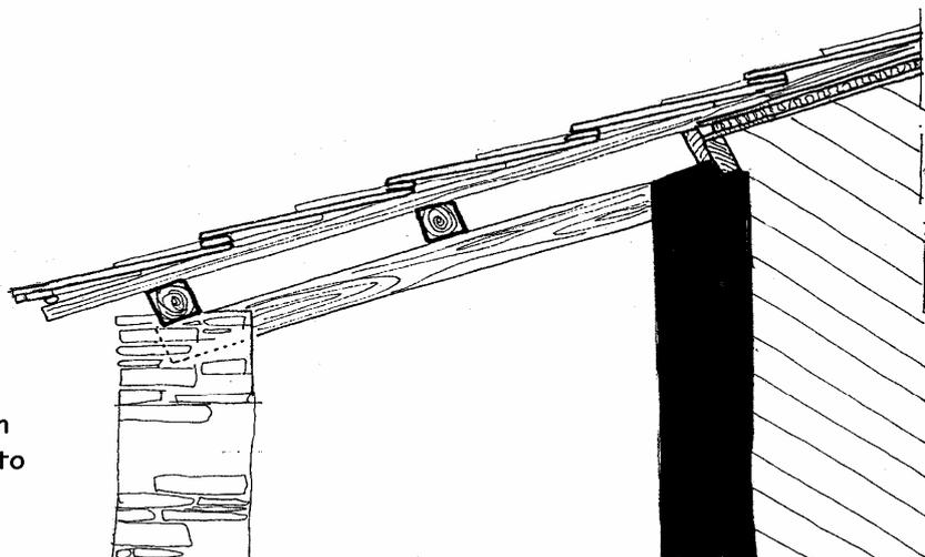
**Struttura ad arcarecci isolata e ventilata per sottotetto abitabile, con prolungamento non isolato su loggiato**
